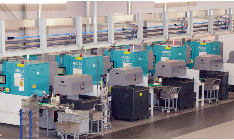
2 Die Niederländer setzen auf große Linien baugleicher CNC-Maschinen, um Aufträge flexibel verteilen zu können (© technotrans)
